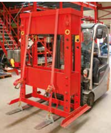
Rakomány biztosítás villaszorítókkal és hevederekkel
