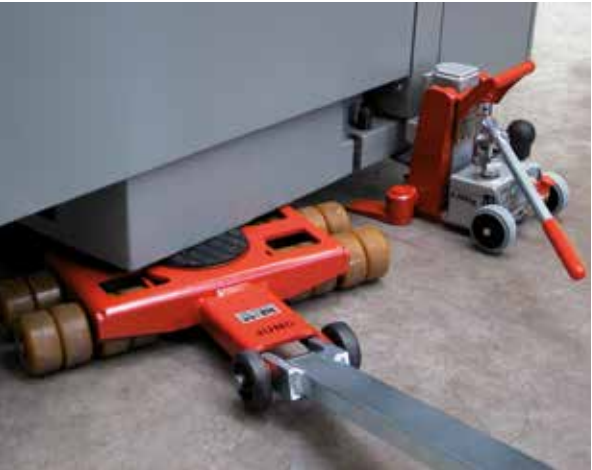
A golyóscsapágyazott görgők könnyű futást garantálnak
