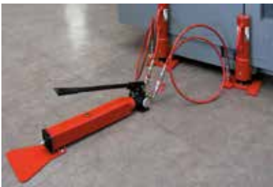
Handpumpe JP 26 im Einsatz mit JHS 10
